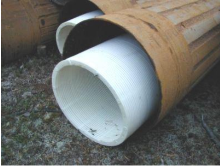
Siiviläputkikaivon valkoinen siiviläosuus ja teräksinen työputki. Kuva: Veli-Pekka Salonen
