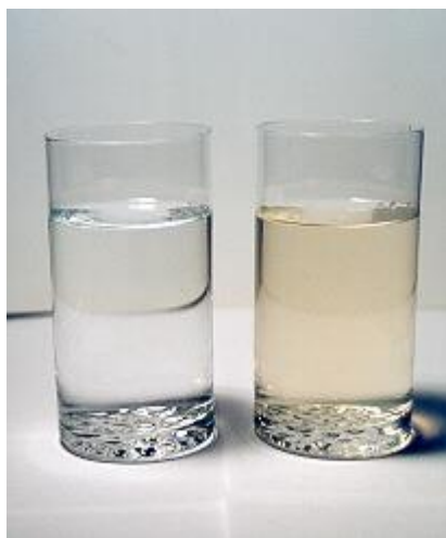
Järn, som har lossnat från vattenledningarna, kan ge vattnet en brun färg. Foto: Johanna Rissanen
