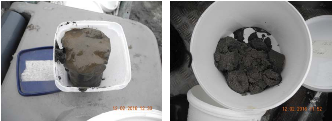
Kuva 2. Esimerkkikuvia tutkimusalueen sedimenttinäytteistä. Vasemmalla pintakerroksen profiili (KL3: 0–10 cm), jossa näkyy hapellinen ruskea lieju pinnalla. Oikealla hiekkaista näytettä (KL1: 30–60 cm).
