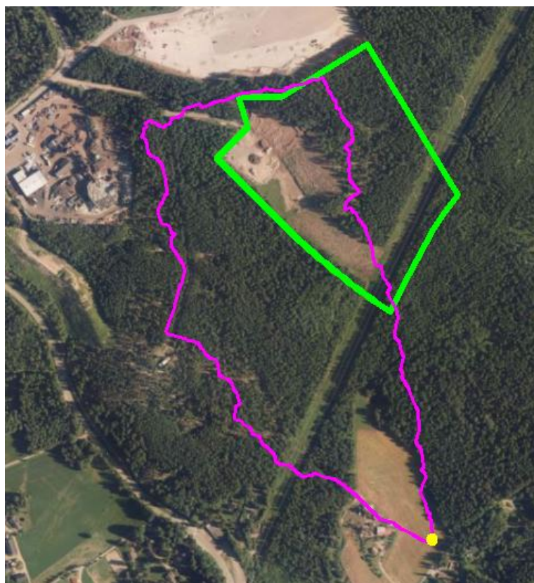
Kuva 3 Purkupiste (keltainen piste), purkupisteen luontainen valuma-alue (pinkki viiva) sekä suunnittelualueen rajausta (vihreä viiva).
